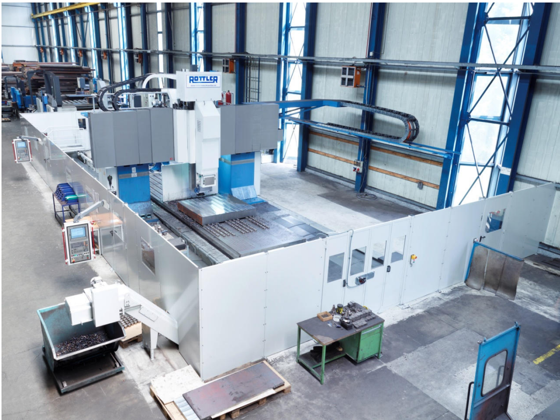
Portalfräsmaschine PFSG 100 in der Halle der Fa. Kontur (BILD 1)
