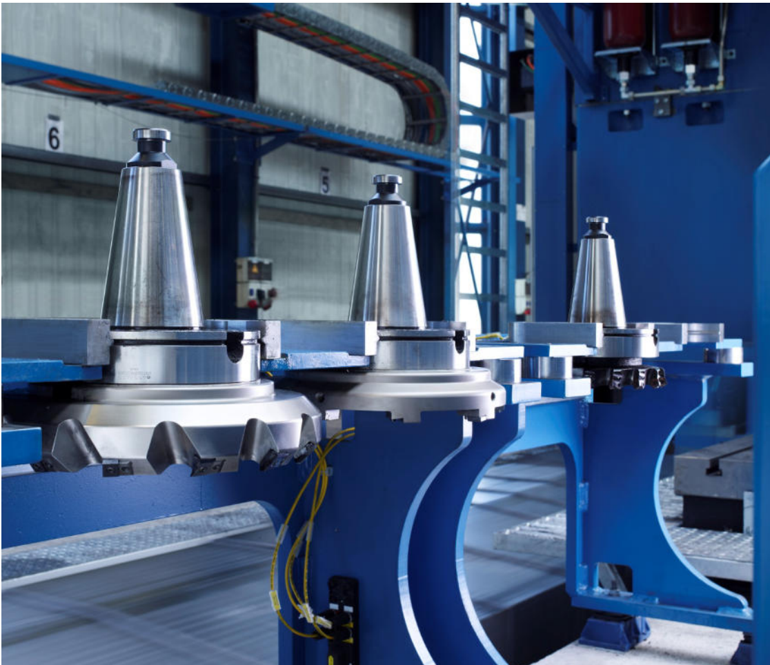
Ablagestation für Werkzeuge (Bild 2)
