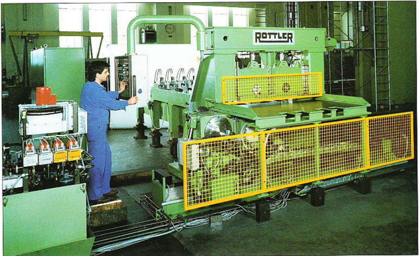
Maschinenvorderseite (Werkstückausstoß) mit Spanntraverse, Sägefräsaggregat und Auflagetisch
