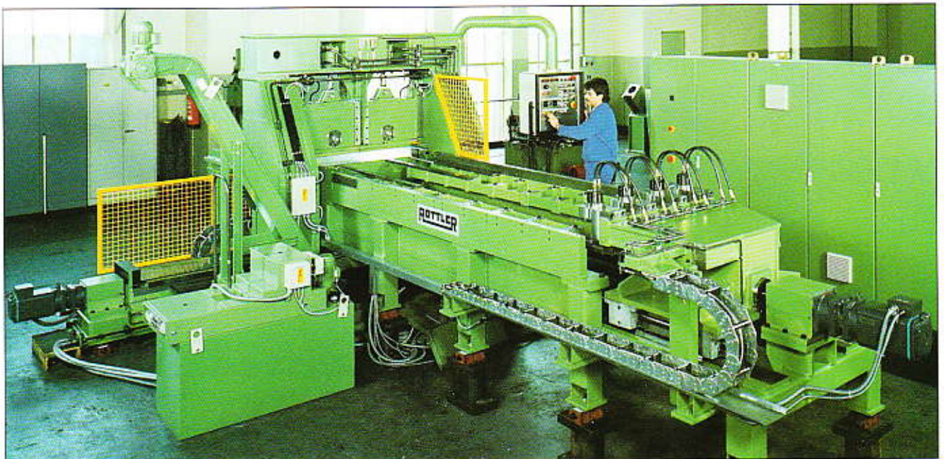
Maschinenrückseite (Werkstückeinlauf) mit Spann- und Zuführtraverse, Vorschubtisch sowie wälzgeführte Werkstückauflage
